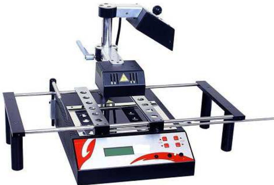
Obrázek 7 Příklad opravárenského pracoviště pro SMT technologie
